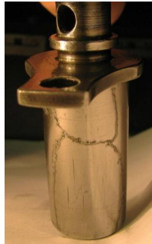
Рис. 5. Контрольный образец из стали 18ХНВА с выявленными дефектами
