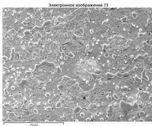
Рис. 2. Участки энергодисперсионного анализа образца из сплава системы Mo–Ti–Zr–C после компактирования при температуре 1550 °С
