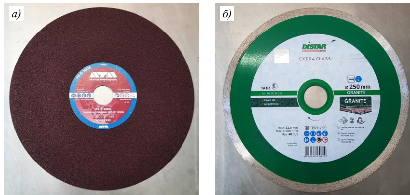
Рис. 2. Абразивные корундовый (а) и алмазный (б) круги
