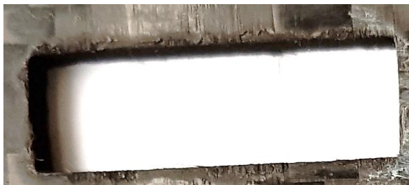
Рис. 16. Поверхность углепластика марки ВКУ-29 после электроэрозионной обработки композитным электродом-инструментом на режиме med
