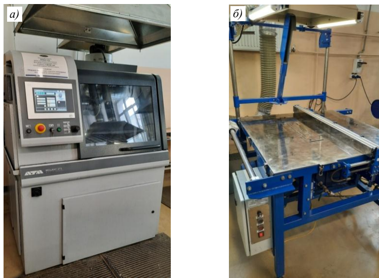
Рис. 1. Оборудование для разрезания плит из ПКМ: a – отрезной станок с водяным охлаждением; б – отрезной станок
