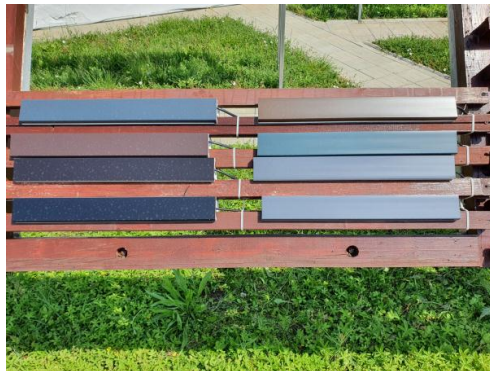
Рис. 1. Экспозиция образцов ПВХ-профиля в ГЦКИ ВИАМ
