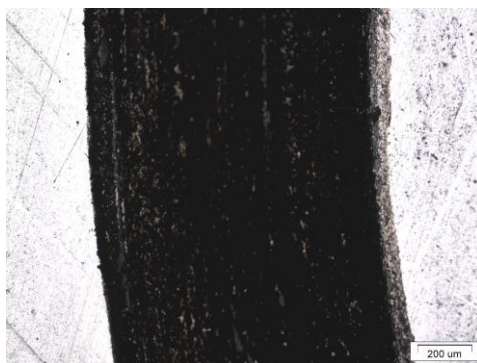
Рис. 5. Вид дорожки износа ( \times 100 ) после испытания на изнашивание в условиях сухого трения скольжения стали ВНС32-ВИ в паре трения со сталью ШХ15-ШД
