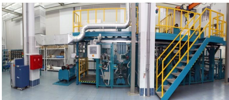
Установка Coatema BL-2800 для изготовления калиброванных прецизионных препрегов
