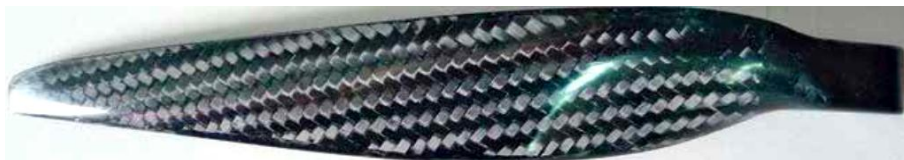
Рис. 4. Лопасть толкающего винта в беспилотном летательном аппарате [11]
