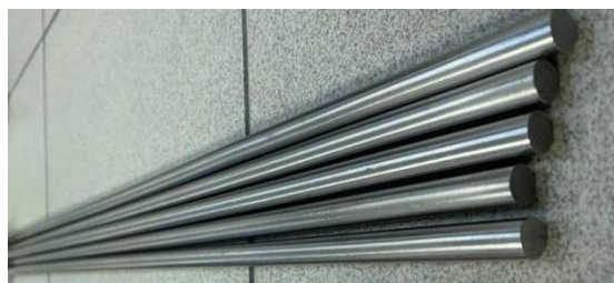
Рис. 1. Внешний вид прутков из псевдо- \beta -титанового сплава BT47 производства АО «Чепецкий механический завод» (г. Глазов)
