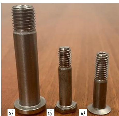
Рис. 2. Внешний вид болтов из псевдо- \beta -титанового сплава BT47, изготовленных в промышленных условиях АО «Нормаль» с плоско-скругленной головкой и короткой резьбовой частью типа Hi-Lok M10 (а), с уменьшенной шестигранной головкой для соединений со специальной переходной посадкой M6 (б) и с потайной головкой с углом 120 градусов типа Hi-Lok M6 (в)
