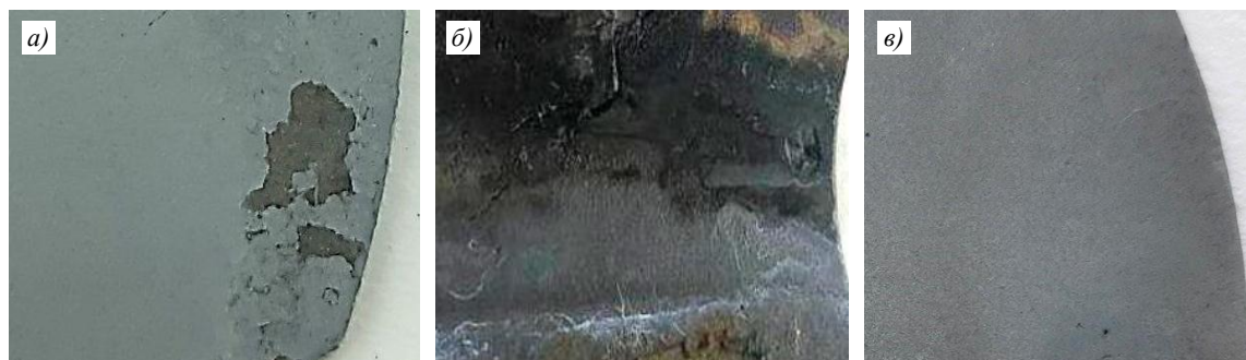
Рис. 2. Внешний вид магнита системы Nd–Fe–B с защитным цинковым покрытием в зависимости от способа подготовки поверхности – активации в растворах 1 (а) и 2 (б), а также в растворе на основе фторидов 3 (в)
