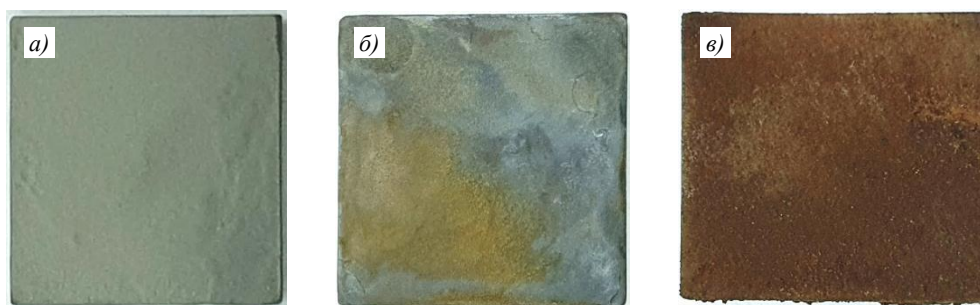
Рис. 1. Внешний вид магнита системы Nd–Fe–B в исходном состоянии (а) и после коррозионных испытаний в камере солевого тумана в течение 15 мин (б) и 24 ч (в)
