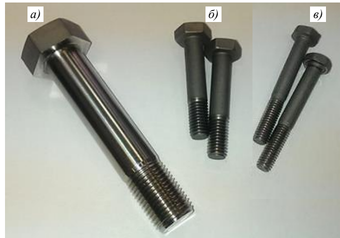
Рис. 4. Высадные болты М16 (а), М8 (б) и М6 (в) из стали ВНС-74, изготовленные методом горячей (а) и холодной (б, в) штамповки головки
