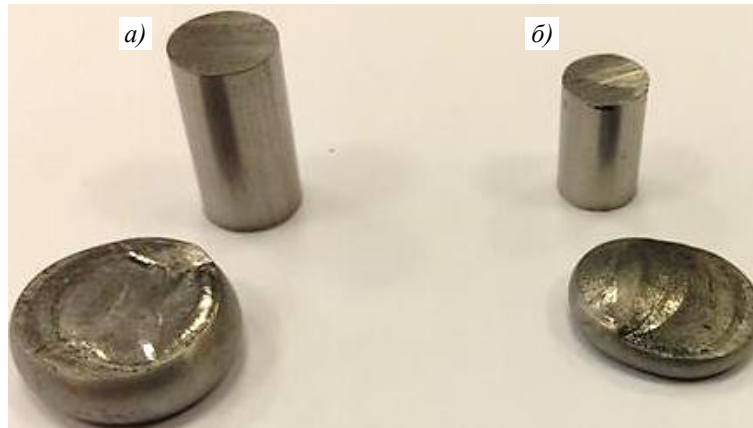
Рис. 3. Вид образцов диаметром 8 (а) и 6 мм (б) после осадки >80 % отожженных холоднокатаных прутков из стали ВНС-74 при комнатной температуре
