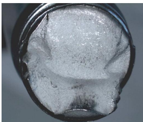
Рис. 5. Излом болта М8 с перекосом 8 градусов в резьбе из стали ВНС-74 после испытания на растяжение
