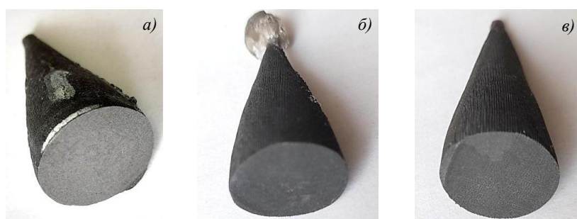
Рис. 3. Ростовые конусы отливок из никелевого жаропрочного сплава, протравленные до проявления дендритной структуры, с монокристаллической структурой (а), с «размытыми» границами (б) и с более контрастными границами (в)
