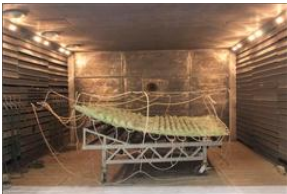
Рис. 12. Фото оснастки в печи при формовании интегральной панели [32]
