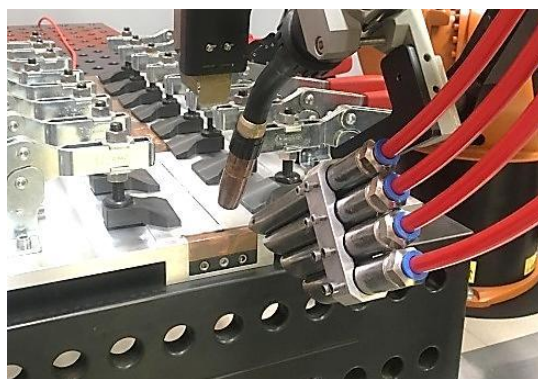
Рис. 2. Проведение лазерной сварки листовых заготовок жаропрочных алюминиевых сплавов В-1213 и 1151 на роботизированном комплексе Laser Weld 8R60
