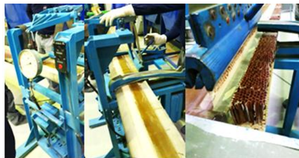
Рис. 4. Общий вид специальной установки для испытаний лопасти несущего винта
