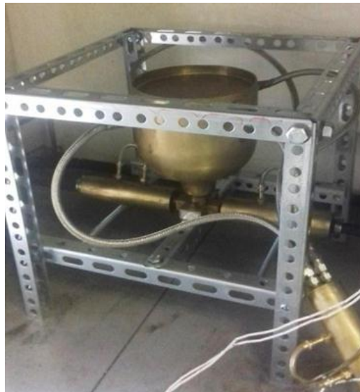
Рис. 3. Монтажная рама с установленной в вертикальном положении горелкой
