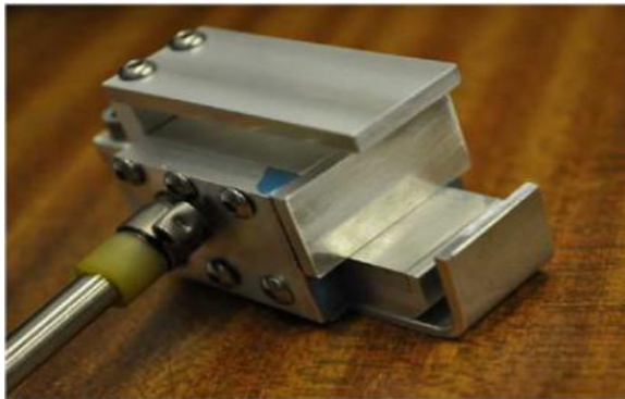
Рис. 5. Испытательный стенд для определения адгезии льда методом горизонтального сдвига
