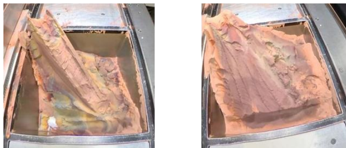
Рис. 1. Фотографии порошка сплава на основе меди и 0,5–1,0 % (по массе) хрома в камере установки DMP Flex 350 (3DSystems, Бельгия) после процесса синтеза
