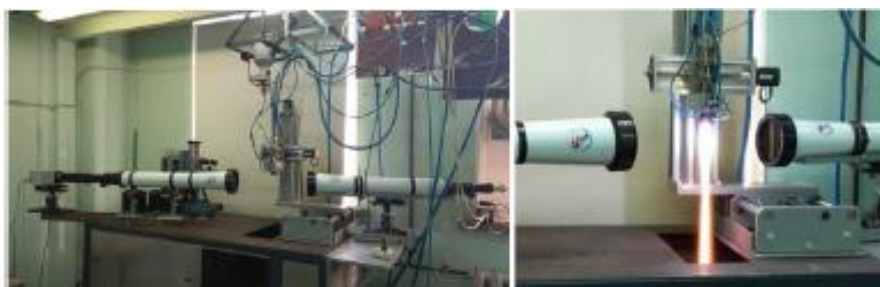
Рис. 5. Внешний вид установки для сфероидизации порошков ниобия
