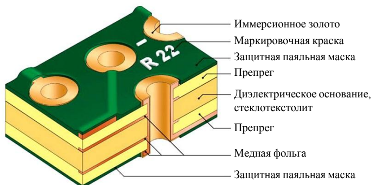
Рис. 2. Схема многослойной печатной платы [12]
