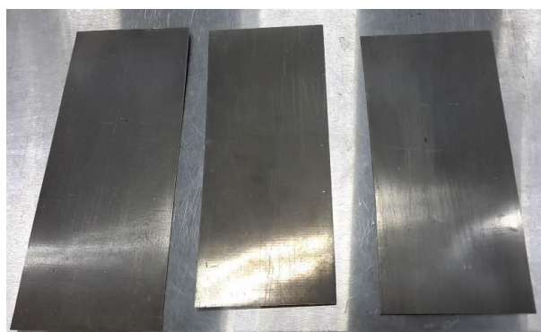
Рис. 3. Внешний вид раската из сплава системы Fe–Cr–Al–Y после прокатки с предварительным подогревом
