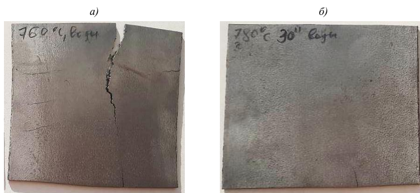
Рис. 2. Внешний вид образцов из сплава Fe–Cr–Al–Y после холодной прокатки: закалка при температуре 760 (а) и 780 °С (б), выдержка 30 мин, охлаждение в воде. Степень деформации \varepsilon составила 10 (а) и 7 % (б)
