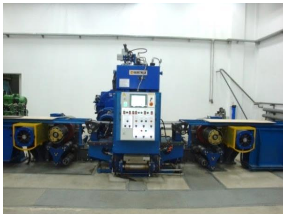
Рис. 1. Внешний вид реверсивного прокатного стана «Дуо-кварто 300» ВЭТЦ НИЦ «Курчатовский институт» – ВИАМ
