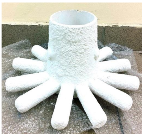
Рис. 2. Внешний вид керамической формы для литья образцов
