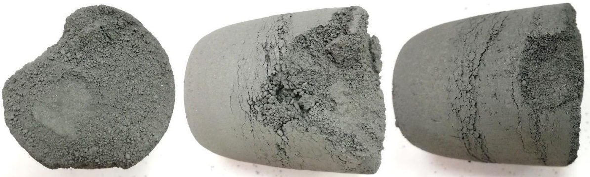
Рис. 2. Спеченная заготовка, полученная после агломерации при температуре в точке 1
