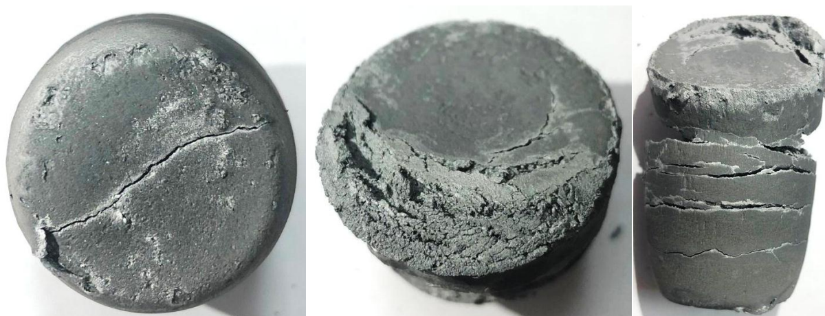
Рис. 4. Спеченная заготовка, полученная после агломерации при температуре в точке 3
