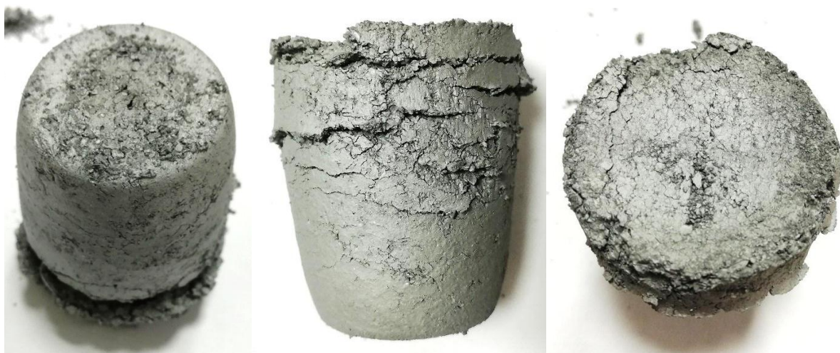
Рис. 3. Спеченная заготовка, полученная после агломерации при температуре в точке 2
