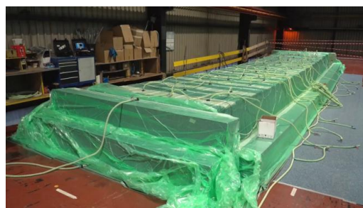
Рис. 8. Подготовленная к процессу вакуумной инфузии заготовка моста из льна и биосмолы [39]
