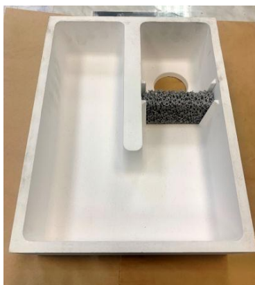
Рис. 1. Пенокерамический фильтр, установленный в металлоприемник
