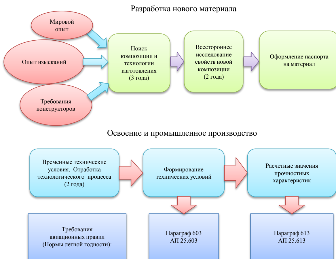
Рис. 13. Схема разработки и промышленного освоения материала
