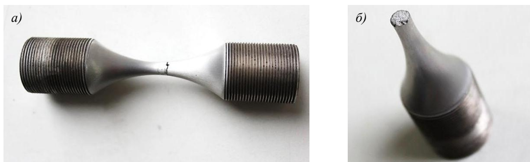
Рис. 2. Общий вид (а) и поверхность разрушения (б) образца 3–2
