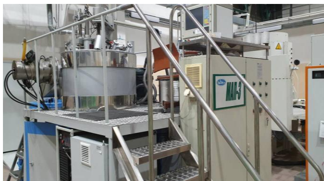
Рис. 1. Внешний вид вакуумно-дуговой установки МАП-3 с автоматизированной системой управления технологическим процессом с ассистированным осаждением
