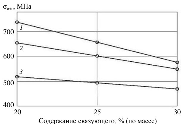
Рис. 8. Диаграмма изменения значений предела прочности при изгибе в зависимости от содержания полимерного связующего в нетермоциклированных стеклопластиков: 1 – однонаправленных; 2 – перекрестно армированных; 3 – квазиизотропных
