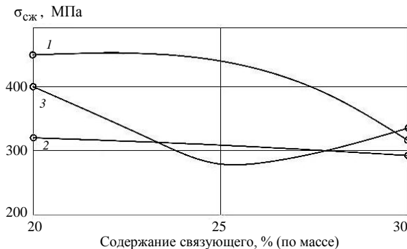
Рис. 6. Диаграммы изменения предела прочности при сжатии для стеклопластиков с различными вариантами армирования (1 – однонаправленные; 2 – перекрестно армированные; 3 – квазизотропные) в зависимости от содержания в них полимерного связующего
