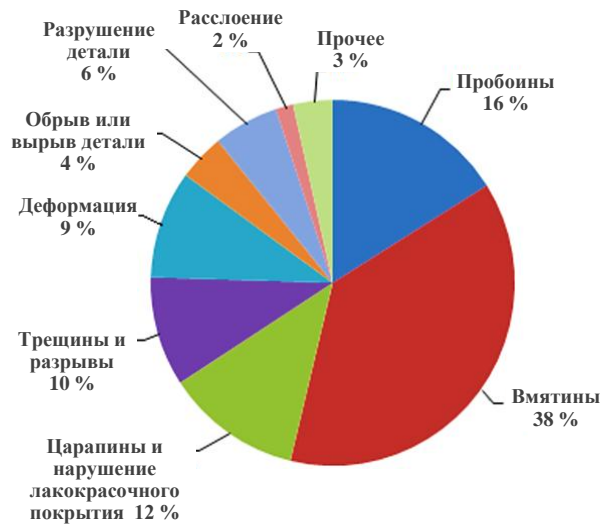
Рис. 8. Распределение повреждений по типам (826 повреждений) [39]
