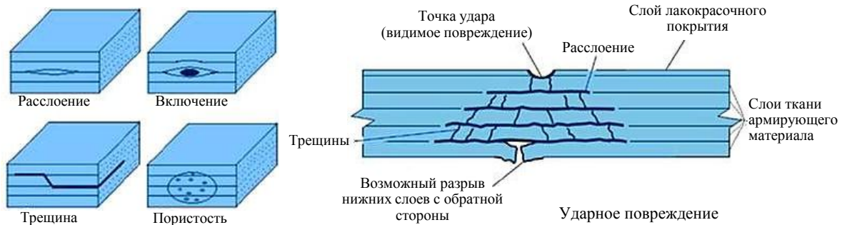
Рис. 7. Дефекты в монолитных полимерных композиционных материалах [39]
