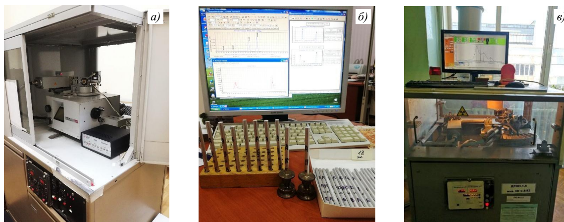
Рис. 5. Дифрактометр ДРОН-4 (а) с микропроцессорной системой автоматизации МСАРД (б) и автоматизированный дифрактометр ДРОН-1,5 (в) с системой автоматизации для контроля затравок «Разбраковщик»
