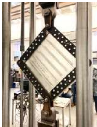
Рис. 3. Проведение испытаний сварных стрингерных панелей фюзеляжа
