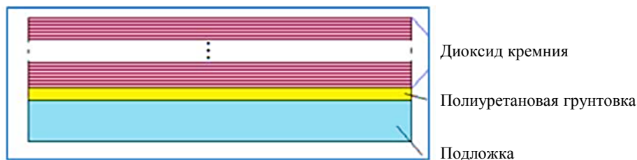
Рис. 1. Схематическая структура покрытия, полученного многостадийным методом
