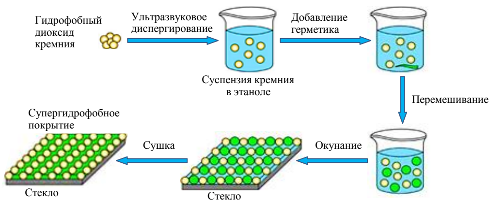
Рис. 2. Схема приготовления супергидрофобного покрытия
