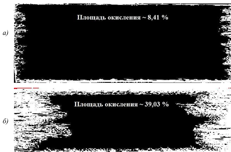
Рис. 2. Состояние поверхности полиимидного углепластика G30-500/PMR-15 после термического старения при температуре 288 °С в течение 197 (а) и 2092 ч (б) [32]
