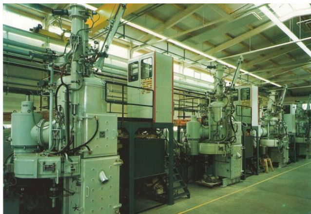
Рис. 4. Производственная линия из установок типа ISP 5 DS/SC фирмы ALD
