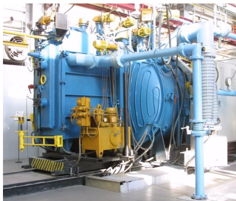
Рис. 11. Плавильно-кристаллизационная печь для направленной кристаллизации с жидкометаллическим охладителем – расплавом алюминия
