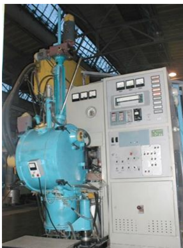
Рис. 15. Установка УВНЭС-4 (с жидкометаллическим охладителем – расплавом олова)
