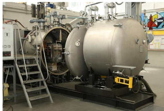
Рис. 14. Промышленная печь УВНС-6 (с жидкометаллическим охладителем – расплавом олова) со шлюзовой камерой
