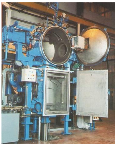
Рис. 3. Установка Consarc для прецизионного литья деталей ГТД с равноосной и направленной структурой
