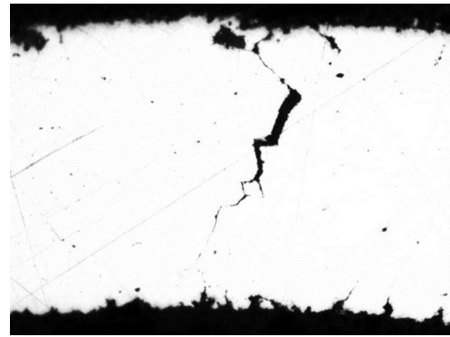
Рис. 3. Сквозная трещина на шлифе без травления, \times 500
