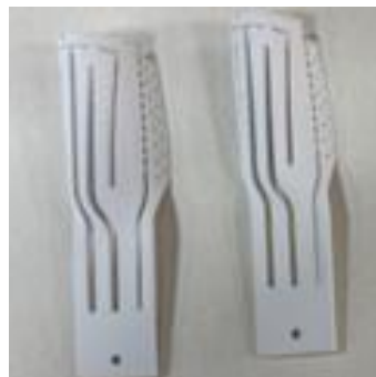
Рис. 7. Прокаленные керамические стержни
