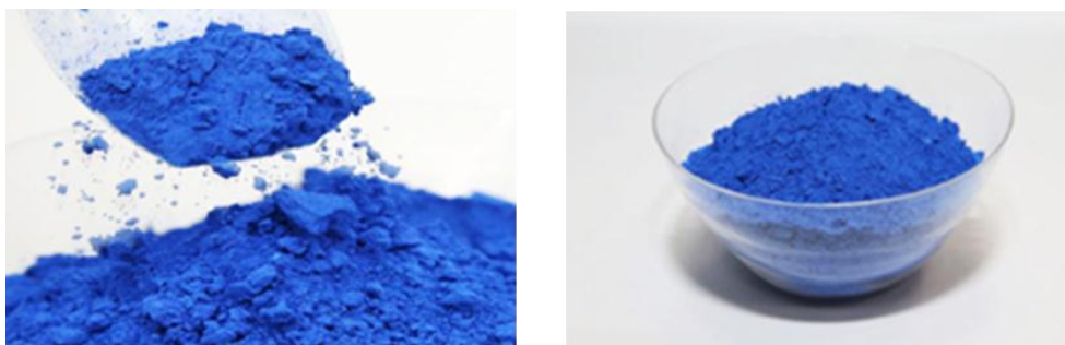
Рис. 1. Модификатор – алюминат кобальта
