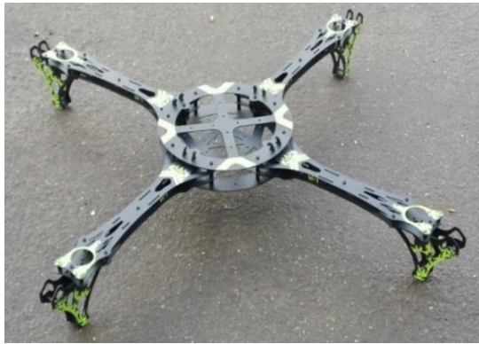
Рис. 7. Готовая рама квадрокоптера из стеклопластика [44]
