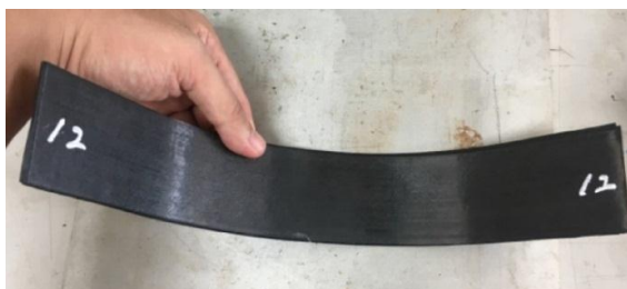
Рис. 3. Элемент шасси БПЛА из углепластика [20]
