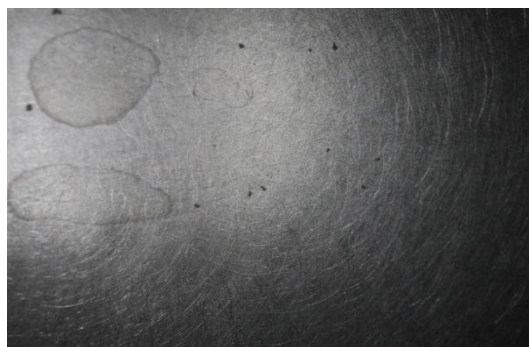
Рис. 3. Подвергнутая зачистке поверхность обшивки воздушного судна, на которой наблюдаются питтинги
