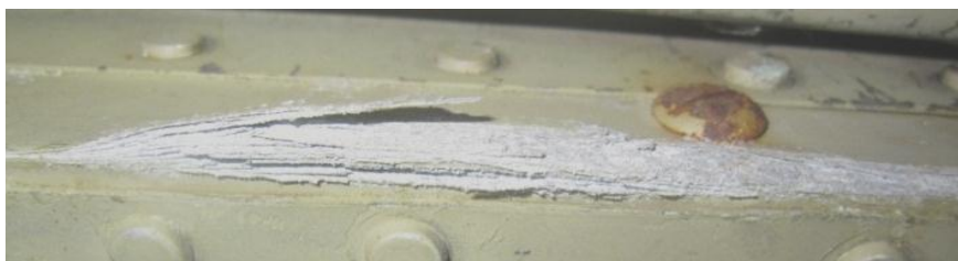
Рис. 2. Расслаивающая коррозия алюминиевого сплава в конструкции воздушного судна
