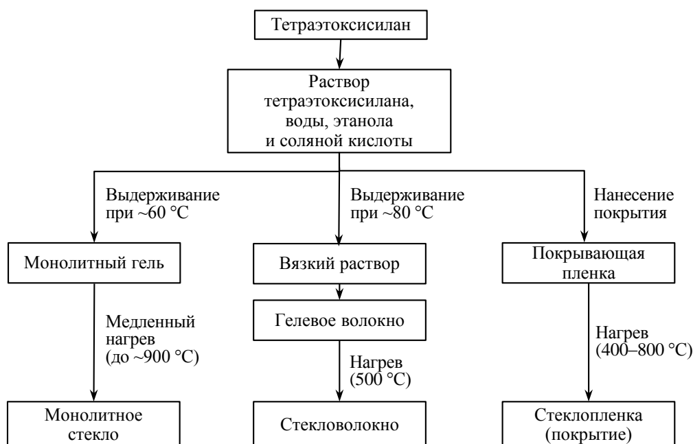
Рис. 1. Технологическая схема получения стекла, стекловолокна и стеклопокрытия
