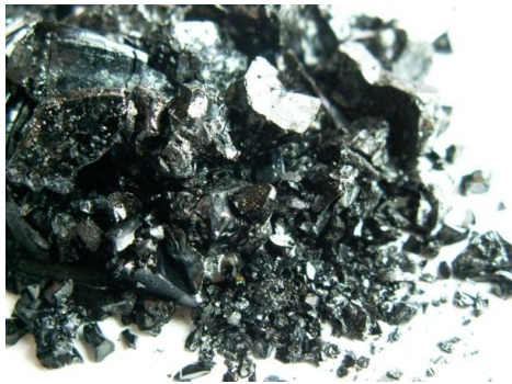
Рис. 7. Внешний вид термообработанного геля с сахаром (температура термообработки 350 °С)
