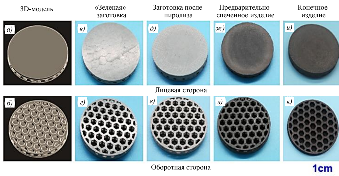
Рис. 3. Легкое керамическое оптическое зеркало из карбида кремния: a, б – 3D-модель для стереолитографии; в, г – «зеленая» заготовка; д, е – заготовка после пиролиза; ж, з – предварительно спеченное изделие; и, к – конечное изделие
