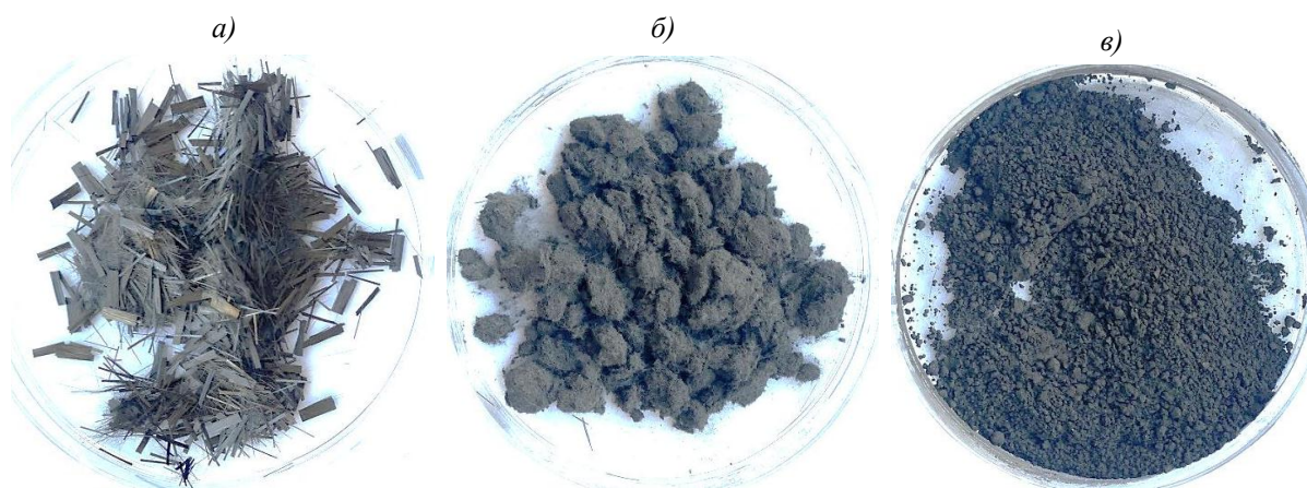
Рис. 1. Внешний вид рубленого (а), измельченного (б) и молотого (в) углеродных волокон
