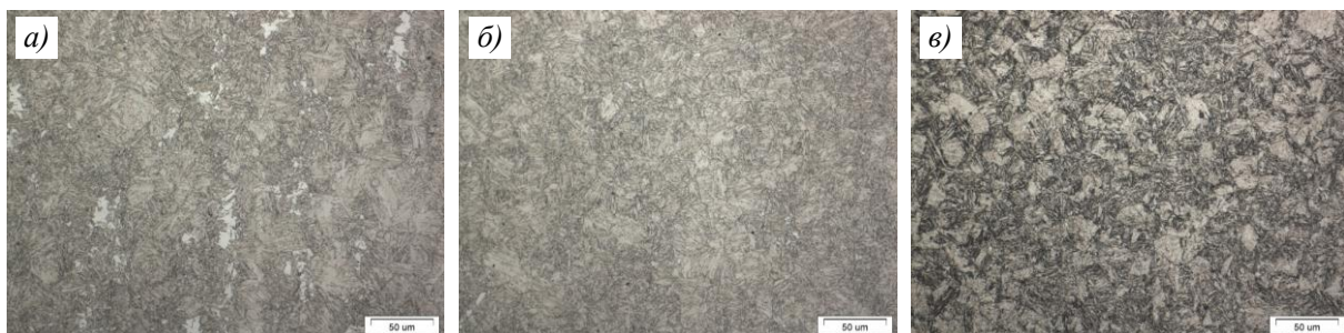
Рис. 2. Микроструктуры ( \times 500 ) образцов из мартенситостаряющей стали 21HKMT после однократного старения (а), двукратного старения (б) и перестаривания (в)
