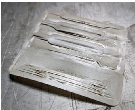
Рис. 1. Образцы лопаток и пленки, полученные из филамента состава 20%ЖКП + 80%ПЭЭК
