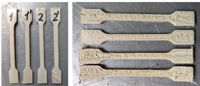
Рис. 3. Образцы лопаток, полученные из филамента состава 40%ЖКП + 60%ПЭЭК
