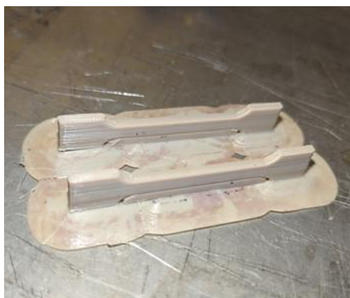
Рис. 5. Образцы лопаток, изготовленные из филамента состава 100%-ный ПЭЭК (печать «ребром»)
