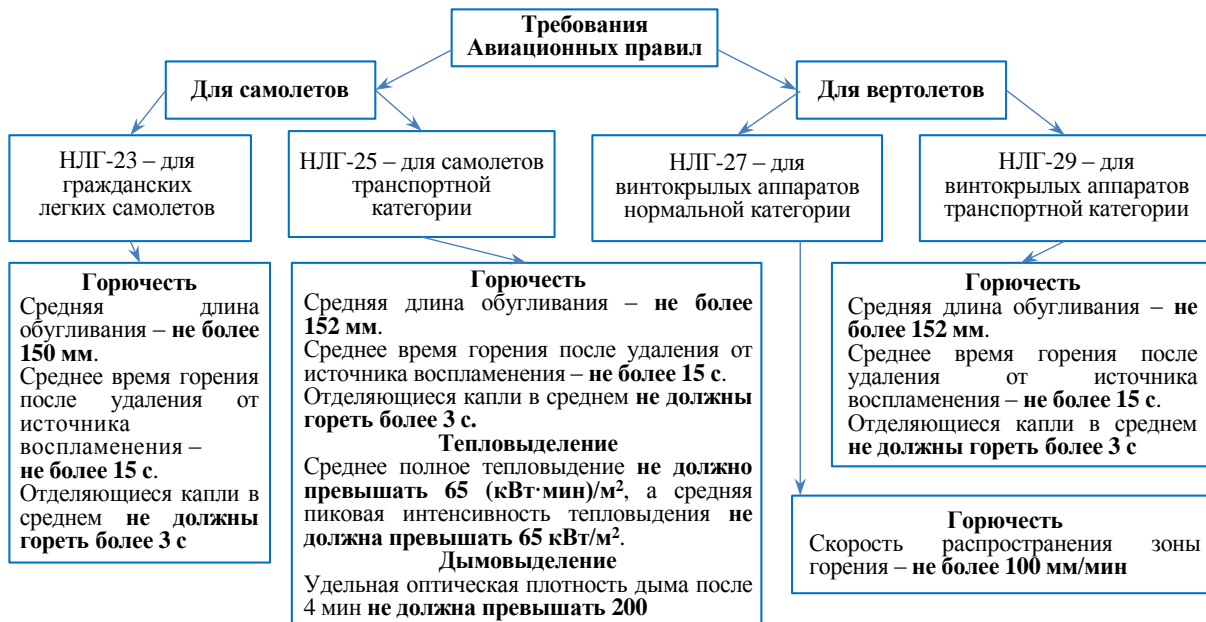
Рис. 1. Требования Норм летной годности (НЛГ) к интерьерным материалам в конструкциях самолетов и вертолетной техники
