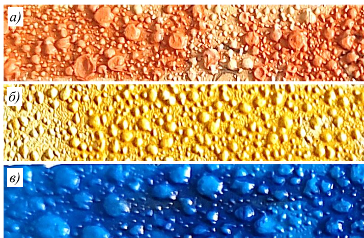
Рис. 4. Внешний вид покрытия АС-1115 на поверхности образцов пластин Г7 (а), Г8 (б) и Г9 (в) после 65 сут увлажнения
