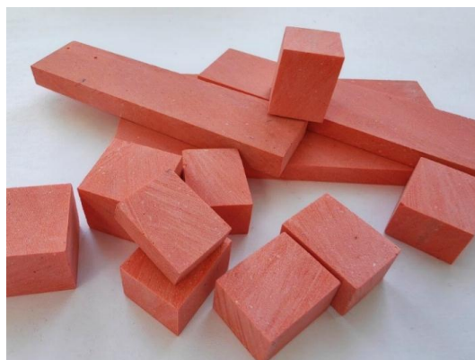
Рис. 3. Образцы полимерного наполнителя-сферопластика марки ВПЗ-25
