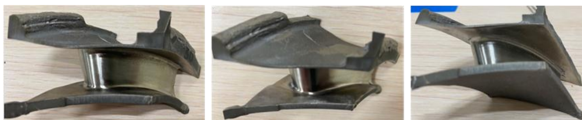
Рис. 5. Сопловые лопатки из сплава ВИН4М-ВИ после механической обработки для нанесения покрытия
