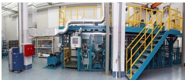
Рис. 1. Пропиточная машина для изготовления препрега по расплавленной технологии
