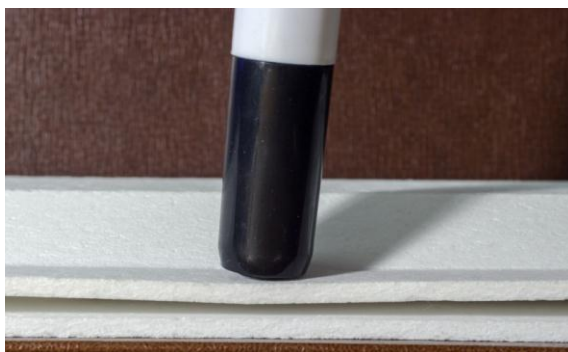
Рис. 4. Образец оснастки с щелевым соплом из высококремнеземного волокна при воздействии изгибающей нагрузки
