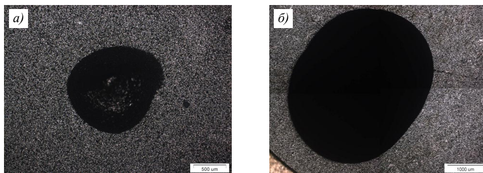
Рис. 6. Внешний вид ( \times 300 ) отверстия после механической обработки твердосплавным сверлом керамики на основе системы ZrB 2 –SiC–BN с содержанием нитрида бора 10 (а) и 20 % (объемн.) (б)
