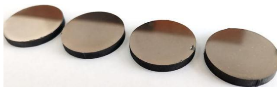
Рис. 1. Внешний вид керамических образцов на основе системы \text{SiC-ZrB}_2\text{-BN} с содержанием нитрида бора 5, 10, 20 и 30 % (объемн.)
